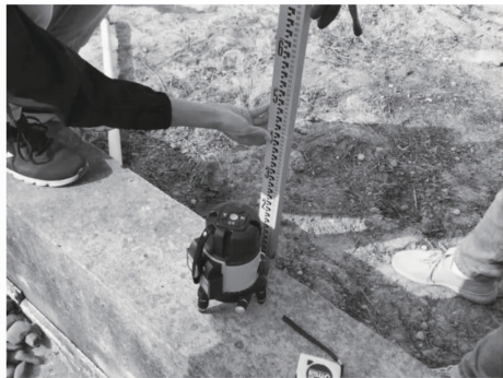
图3 学生对场地进行高程测定
