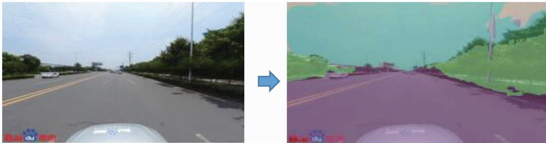
图 2 语义分割图像分割示例 Fig. 2 Example of semantic segmentation image segmentation
