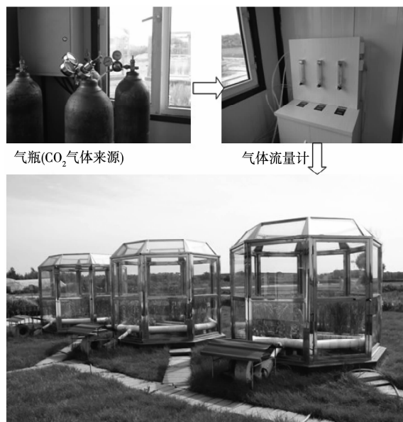
图 1 OTC 运行设备及流程
