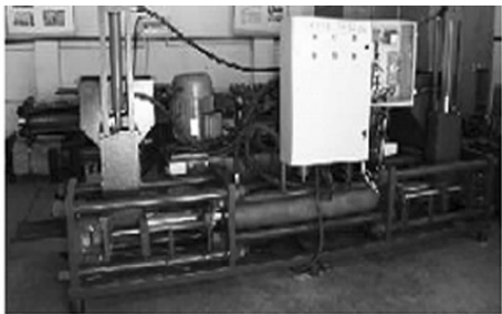
图 1 液力双向挤压常温成型机
