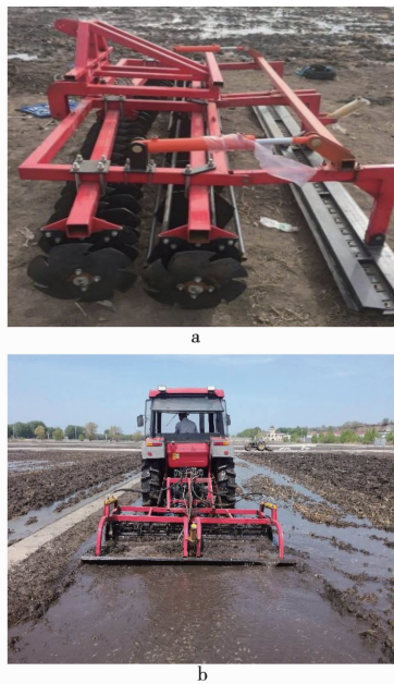
图 2 无驱动搅浆机整机结构(a)和田间搅浆作业(b)
