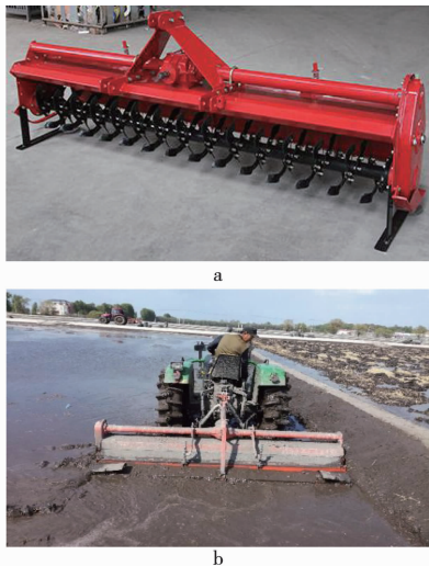
图 1 有动力搅浆机整机结构(a)和田间搅浆作业(b)
